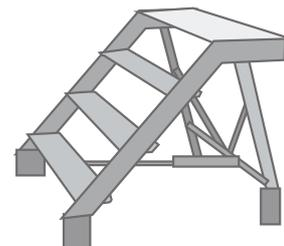
▲ Mit dem Einsatz mobiler Mauertreppen, Rollgerüste oder Arbeitsbühnen können aufwändige Montage-rüstungen eingespart werden.
