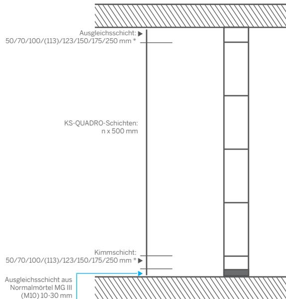
Seine Variabilität beweist das KS-QUADRO-System auch bei der Gestaltung unterschiedlicher Geschosshöhen. Die einfache Kombination des KS-QUADRO-Regelformats mit Ergänzungs- und Kimmsteinen erlaubt hierbei eine große planerische Freiheit bzw. Flexibilität. Auch durch Erhöhung der Mörtelschicht auf maximal 30 mm in der untersten Lage ist jede weitere Zwischenhöhe erreichbar.
