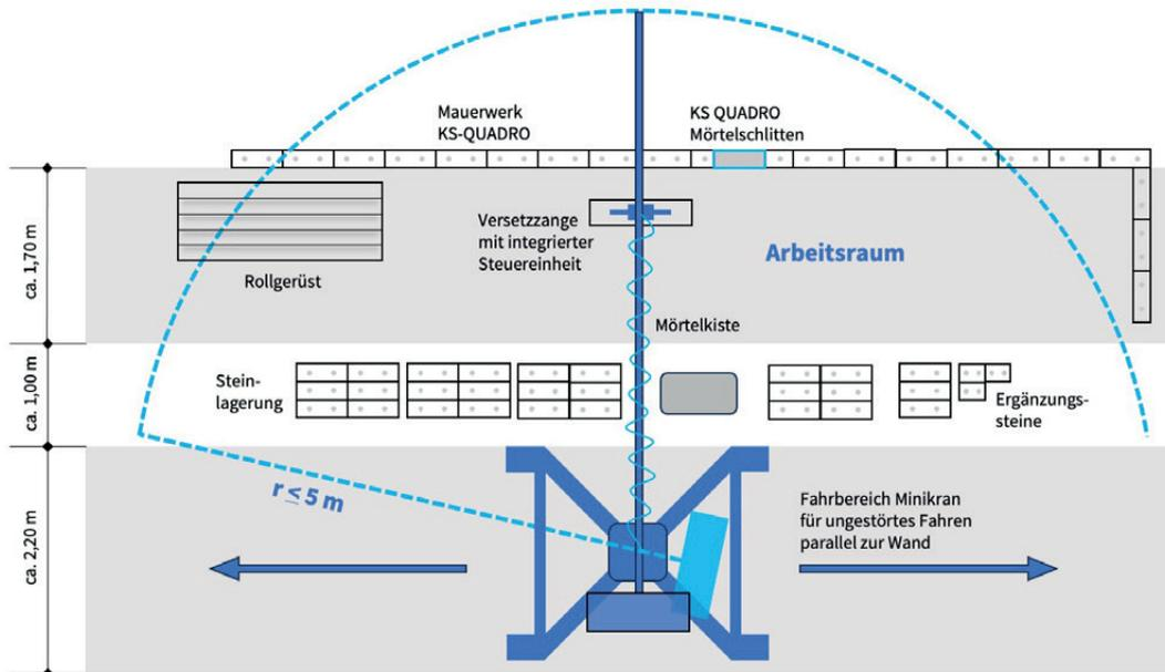
▲ Die richtige Gestaltung des Arbeitsplatzes ist Voraussetzung für effektives Arbeiten. Optimal ist ein Arbeitsraum von ca. 1,70 m zwischen Material und zu mauernder Wand. Der Abstand zwischen Versetzgerät und Wand sollte einen Kranradius von 5 m nicht überschreiten.
