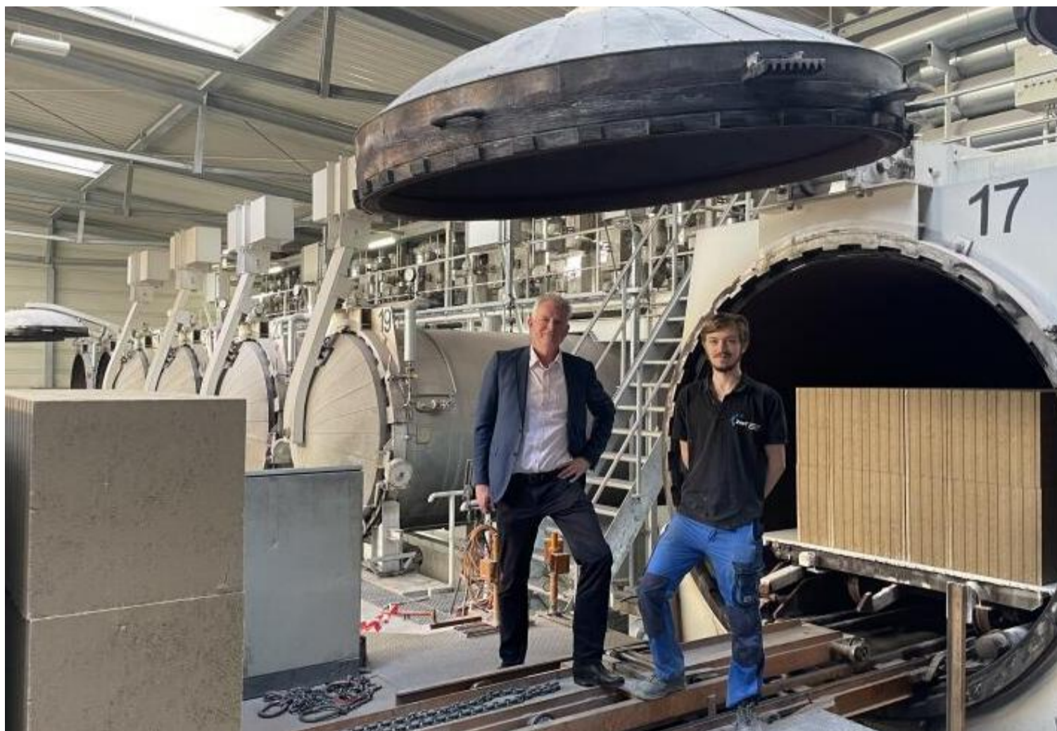
Dr. Hannes Zapf mit einem Mitarbeiter aus der Produktion vor einem der großen Dampf-Härtekelles des Kalksandstein-Unternehmens. Bei etwa 200 Grad Celsius werden die Rohlinge unter Wasserdampfdruck sechs Stunden lang gehärtet.
