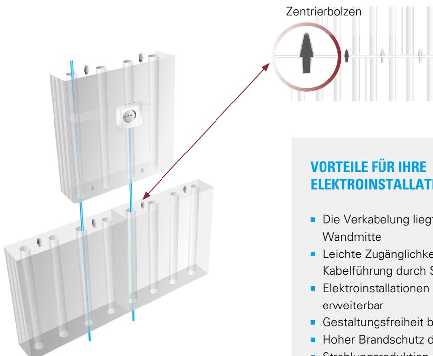
Die Zentrierhilfe – auch Zentrierbolzen genannt – garantiert bei KS-QUADRO *ETRONIC* von Grund auf passgenaue, vertikale Installationskanäle ohne Öffnen bzw. Schlitzen der Wand.
