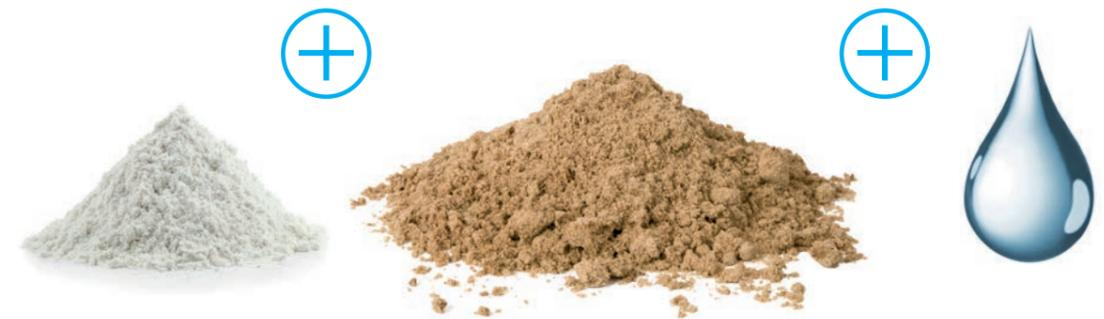
Kalksandsteine bestehen aus **Kalk, Sand und Wasser**. Durch die Herstellung mit Härtung im Dampfkessel bei niedrigen Temperaturen von nur ca. 180 °C, entsteht ein Mauerstein, dessen mineralisches Gefüge dem von natürlichem Sandstein entspricht.
