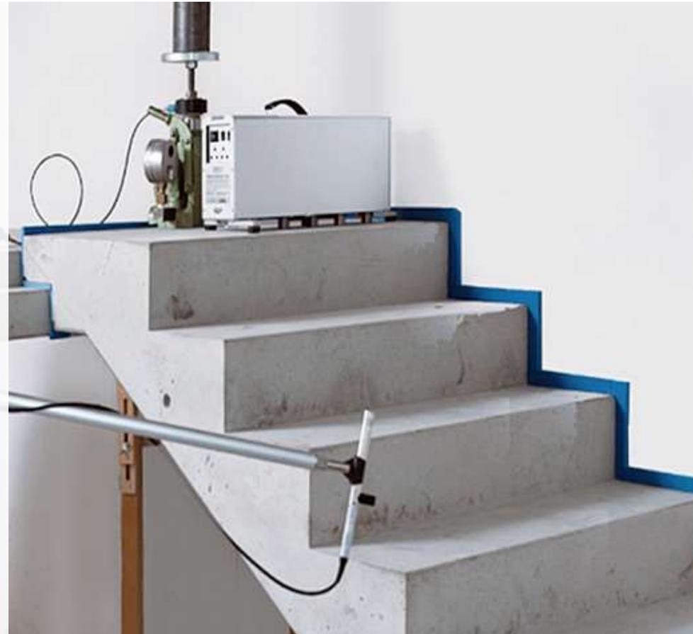
\* von Trittschalldämmprodukten bei Stahlbetontreppen
