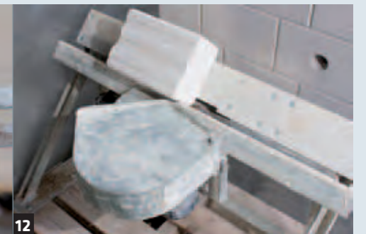
12 Bei größeren Mengen werden gesägte Passsteine mit der Fasenmaschine angefast.
