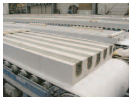
Bild 13: KS-Flachstürze nach dem Verfüllen.
