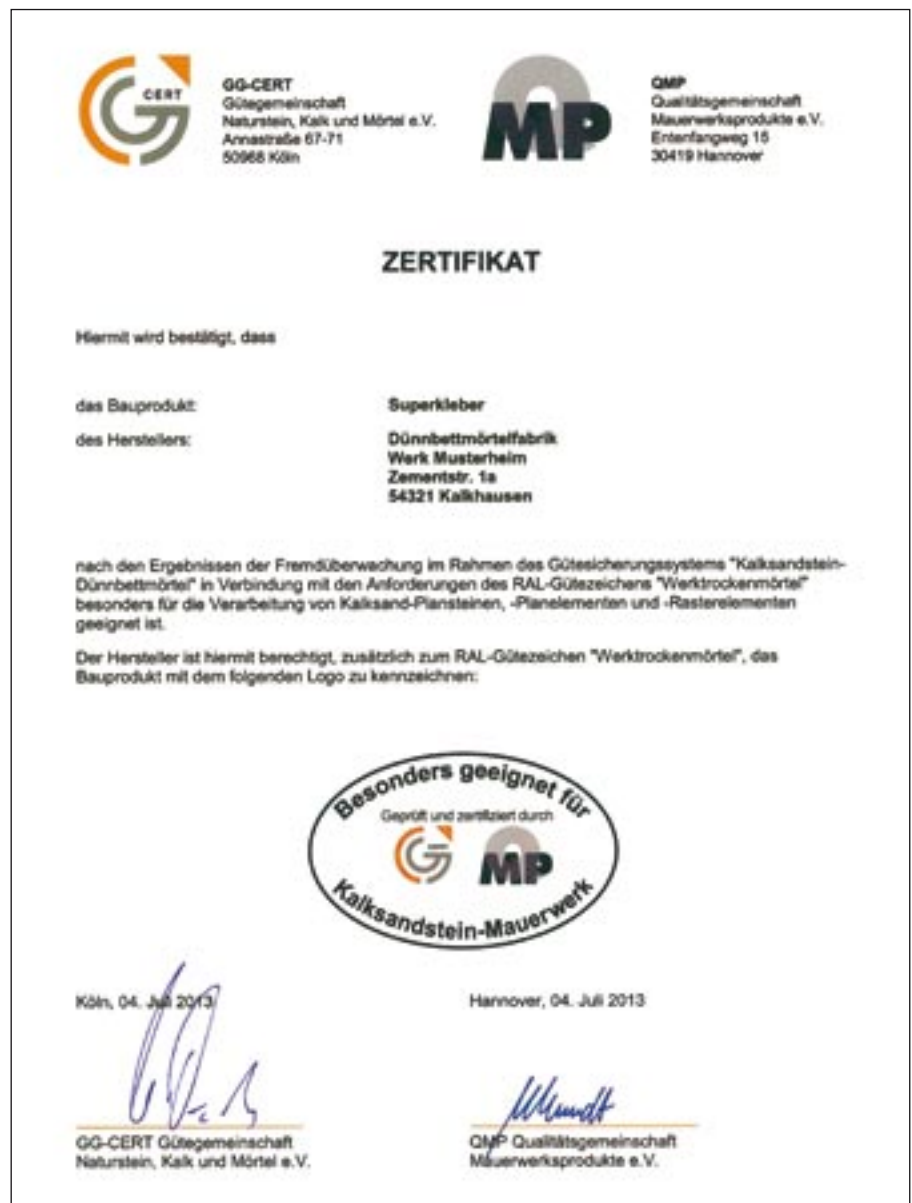
Bild 2: Beispiel-Zertifikat für regelmäßig güteüberwachte KS-Dünnbettmörtel
