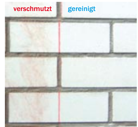
Bild 25: Reinigungseffekt, Beispiel Reinigung mit Schleifpapier, Körnung 140
