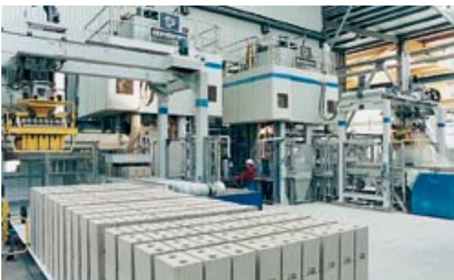
Bild 5: Nach dem Mischen werden die Rohlinge gepresst.
