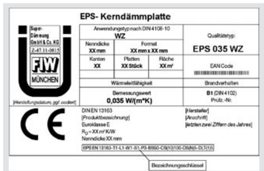
Bild 5: Beispiel eines Etiketts eines EPS-Dämmstoffs für die Anwendung als Dämmschicht in zweischaligem Mauerwerk (Anwendungstyp WZ) einer fiktiven Firma „Super Dämmung“ mit Überwachung durch das FIW München
