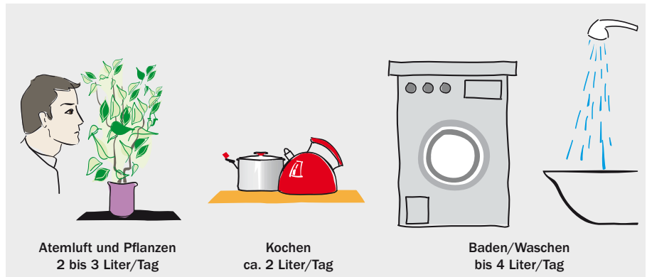
Bild 19: Entstehung von Wasserdampf in einem 4-Personen-Haushalt
