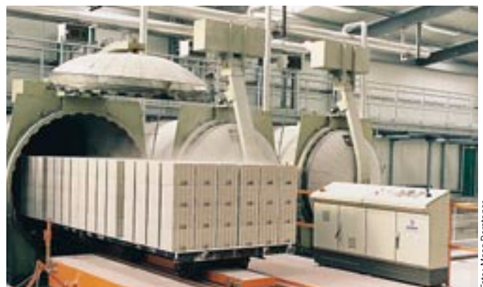
Bild 6: Das Härten der Rohlinge erfolgt in Dampf-Härtekesseln.
