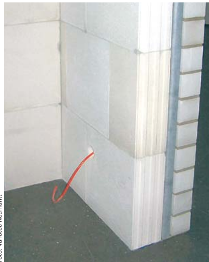
Modell einer zweischaligen Außenwand mit VIP-Dämmung
