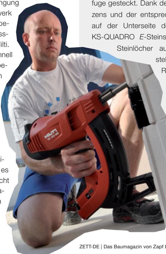
1.200 Bolzen kann das GX 120-ME in einer Stunde befestigen.
