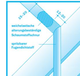
Dehnungsfuge mit spritzbarem Fugendichtstoff.
