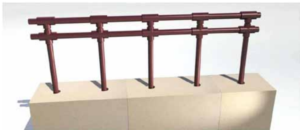
In den KS-QUADRO E Wänden befinden sich mittig im 12,5 cm Abstand von Wandkopf bis Wandfuß lot-rechte Installationskanäle. Alle 25 cm werden Temperiermodule in die Kanäle nach einem vorgegebenen Installationsplan gesteckt. Sie sind unsichtbar und liegen geschützt in der Wand – geschützt auch vor Beschädigungen durch Bohren oder Dübeln. Foto: KS-QUADRO Bausysteme GmbH
