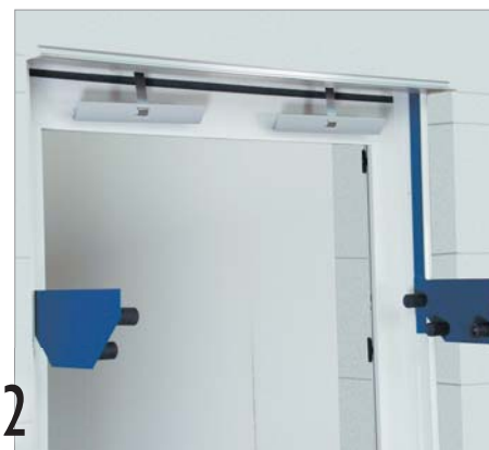
2 Gurtband auf Gurtscheibe aufrollen und lange Federbugel (mind. 23 cm) in der Teleskopwelle einhängen.
