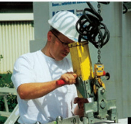
KS-QUADRO Minikran mit KS-Bügelgreifer.
