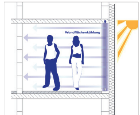
KS-QUADRO THERM sorgt durch Strahlungswärme/-kühle für höchste Behaglichkeit in Räumen bei deutlich reduziertem Energieverbrauch. Sie gewinnen Nutzfläche durch entfallene Heizkörper.
