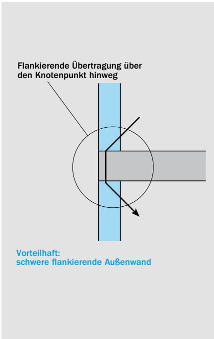
Bild 24: Flankierende Übertragung (vertikal) über die Außenwand
