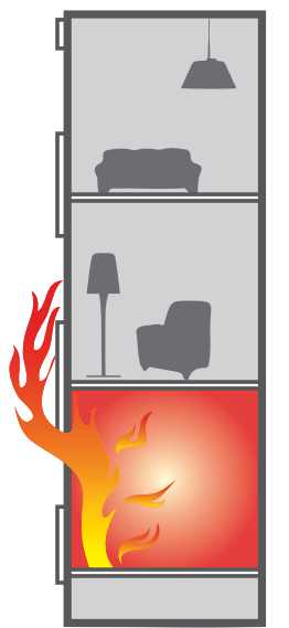
Bild 28: Brand „innerhalb“ eines Gebäudes (Raumbrand)
