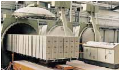
Die Härtung von Kalksandstein erfolgt in luftdichten Druckkammern
