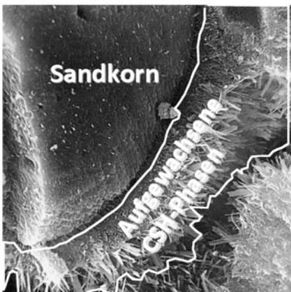
Bild 2/2: Raster-Elektronen-Mikroskopaufnahme (REM) von Kalksandstein: Sandkorn mit CSH-Phasen
