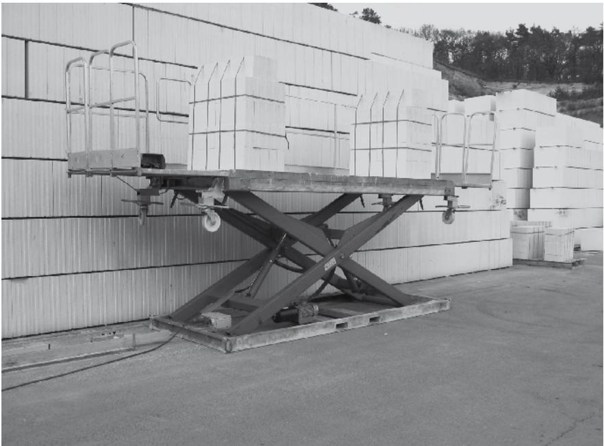
**Bild 6/3: Hydraulisch höhenverstellbare Arbeitsbühnen führen zu effektivem und belastungsarmem Mauern von Hand.**
